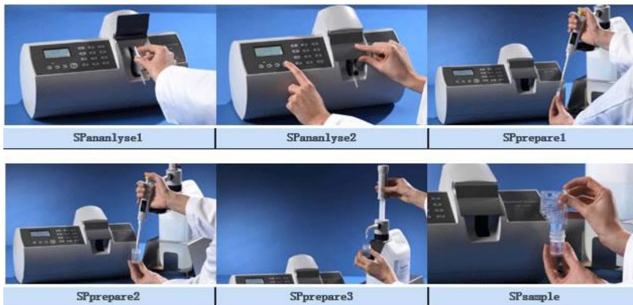
**NucleoCounter SP-100** 是丹麦 ChemoMetec 公司依据其有别于传统精子密度仪的专利开发出的全新一代精子密度仪。通过内置的荧光显微镜来探测精子细胞核所发出的信号。这种直接测量精子的方法与传统根据比尔-朗伯定律间接测量精子密度的方法（15-18%误差率）相比具有更高的准确率。（准确率≥97%）
